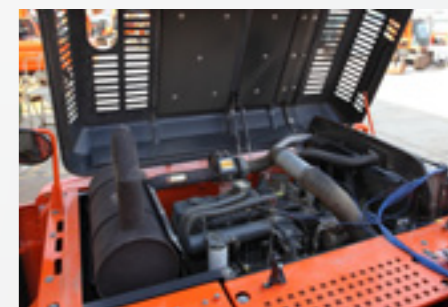
Механический двигатель с высокоэффективными фильтрами
